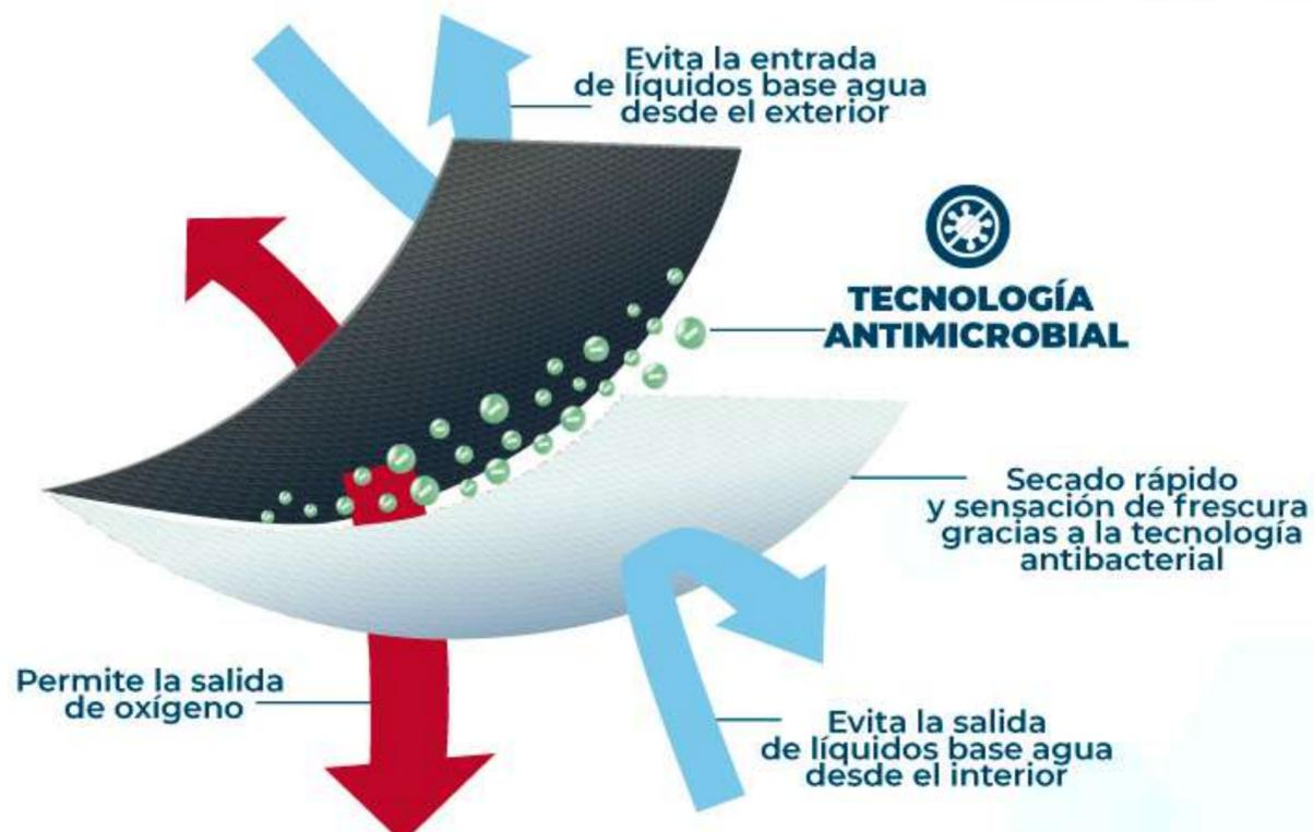
Entre mayor permeabilidad menor capacidad de filtración de un material. **Así mismo se debe garantizar que el aire pueda pasar a través de la tela**, pues de otra forma no se podría respirar, el aire entraría por los lados y estaríamos respirando sin ningún filtro a pesar de estar usando un **tapabocas**.
